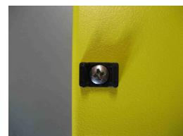
Nun von der Rückseite durch den rechteckigen Ausbruch den Kabelbinder führen, auf der Vorderseite um die Flächenlampe und wieder zurück zur Unterseite. Dort den Kabelbinder in das Endstück einfädeln und locker anziehen. Den Vorgang für alle drei Befestigungen durchführen.
