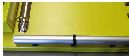
Die Position der Flächenlampe auf der Vorderseite ausrichten (Taste oben) und anschließend die drei Kabelbinder auf der Rückseite richtig festziehen. Den überschüssigen Kabelbinder abschneiden. Den Vorgang für alle drei Befestigungen durchführen.
